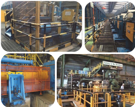
รั้วกันพื้นที่การทำงานของเครื่องจักรและทางเดินบนสายการผลิต
